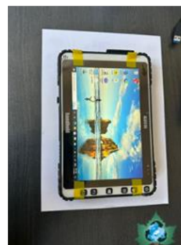
Fig. 7 Tabletă de teren Algiz 8x cu soft Carlson Survpc 6- evidențiere în prim plan
