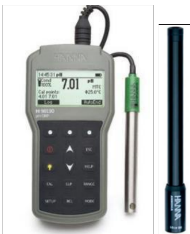
Figura 5. pH metru profesional impermeabil pentru pH/ ORP/ISE și temperatură și electrod de CO 2
